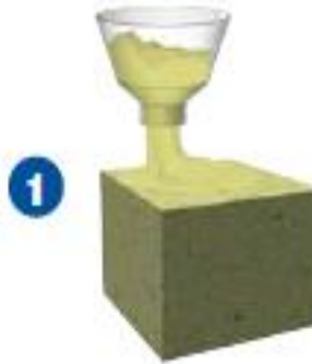
1 PENETRON ADMIX karışım sırasında betona eklenir.
