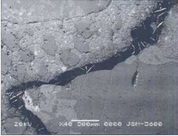
Resim 21 Bir çatlakta oluşan Penetron kristallerinin Geri Saçılmış Elektron Görüntüsü (BEI) 7 .
