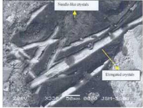
Resim 22 Çatlaklarda oluşan iğnemi uzun Penetron
